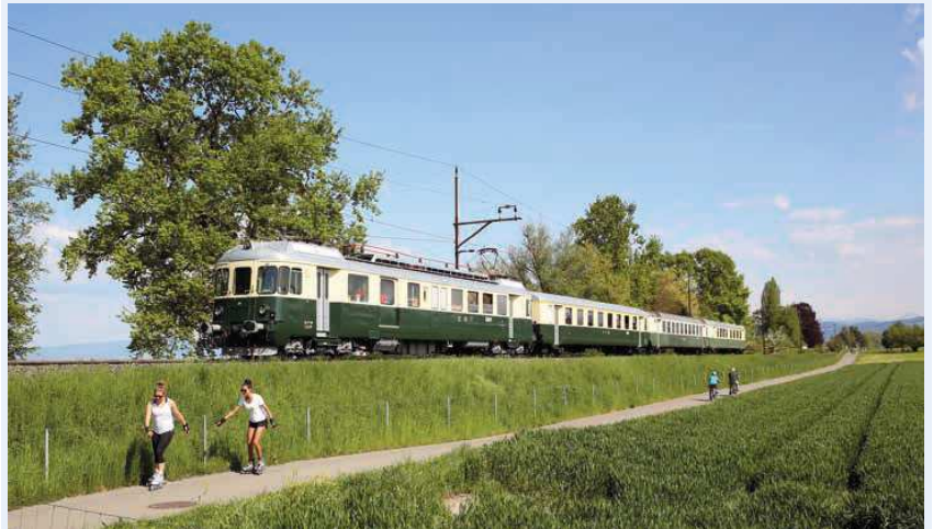
Der VPM-Pendelzug BDe 4/4" 201 (ex SOB-BDe 4/4 82) - A 515 (ex SBB) - B 227 (ex SOB) - ABt 202 (ex SOB) auf der Heimfahrt nach Willisau am 7.5.2016 zwischen Arbon und Egnach mit H-Profil-Masten und Isolatoren-«Böckli» plus Speiseleitung. Foto: G. Trüb
